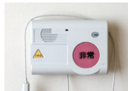
緊急呼出装置
